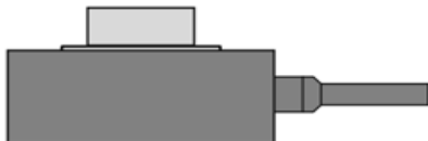
图 2 负载加在工作台的台面中心
