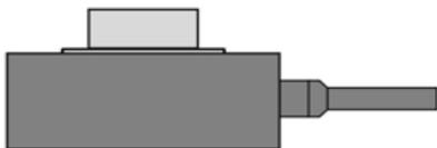
图 3 负载加在工作台的台面中心
