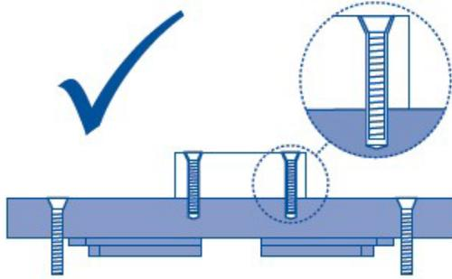
图 6 正确的螺栓连接方式
