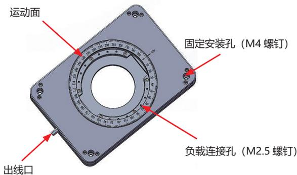
图 2 N61.R5E/K-C1 安装示意图
