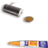
图 5 镜片粘接剂及镜片转接架
