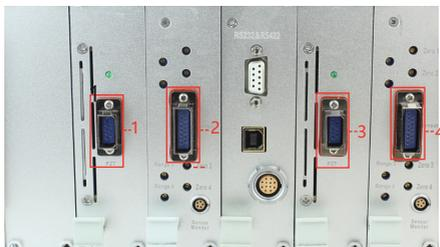
E00.D12AL-V4 控制器前面板接口与 XD502 压电偏摆台连接器对应关系如下：
