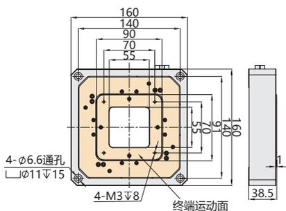
图 1 XD502 压电偏摆台外形尺寸
