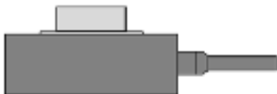
图 4 负载加在工作台的台面中心
