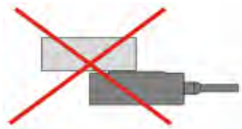
图 6 禁止加载较长负载且加在活动台的一侧
