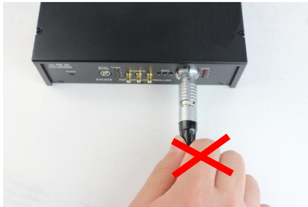
错误的的线缆插拔方式
